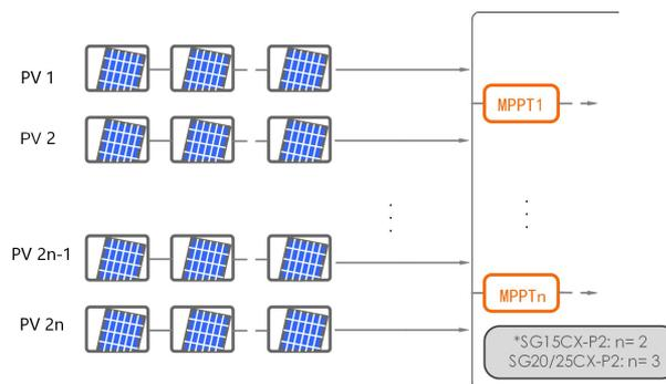
Figura 5-4 PV Input Configuratinon
