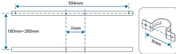
**Etapa 3** Fixe o suporte de instalação nos canais de aço em U com parafusos.
