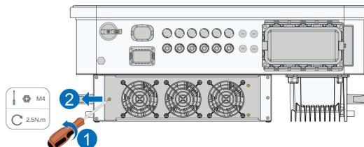
**Etapa 3** Pressione a protuberância do gancho de trava, desconecte a junta de conexão do cabo para fora e solte o parafuso no suporte do ventilador.
