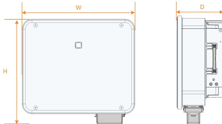
Figura 2-3 Dimensões do inversor (em mm)
