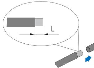
**Etapa 2** Crimpe as extremidades dos cabos utilizando alicates apropriados.
