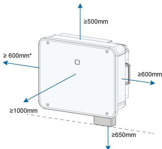
\*Quando esta distância for menor do que a distância mostrada, retire o inversor do suporte ou da parede antes de realizar a manutenção dos ventiladores.
