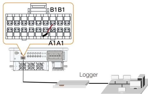
No caso de múltiplos inversores, todos eles podem ser conectados por meio de cabos RS485 de forma encadeada, como mostrado na figura a seguir.
