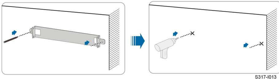
**Etapa 2** Faça furos com uma furadeira de impacto. Limpe os orifícios, insira as buchas de expansão nos furos e fixe-os com um martelo de borracha. Utilize uma chave inglesa para apertar a porca e fixar a extremidade do parafuso, retire a porca, a arruela de pressão e a arruela plana para reposição.
