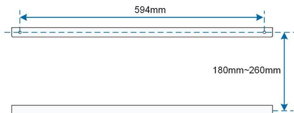
**Etapa 2** Fixe o suporte de instalação no canal de aço em U com parafusos.
