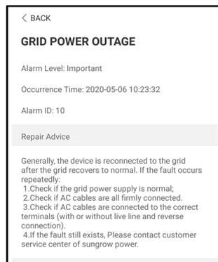
**Figura 7-8** Informações detalhadas do alarme de falha
