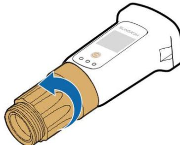
**Etapa 4** Passe o cabo de rede pela porca giratória e pela gaxeta. Depois, lance o cabo pela abertura da vedação. Por fim, insira o cabo através do compartimento.
