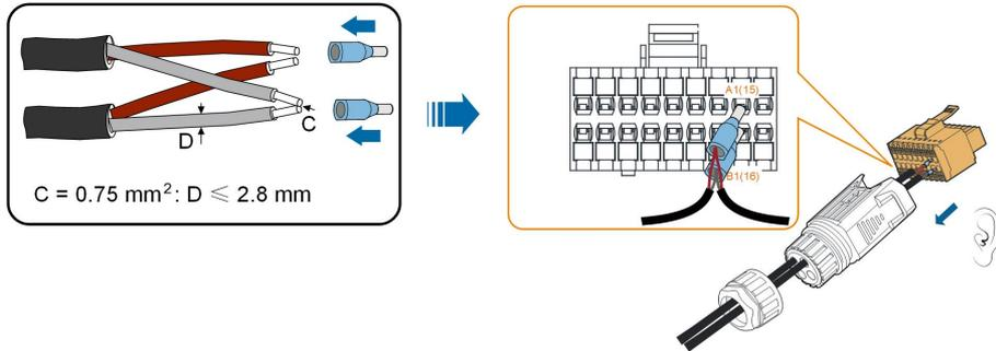
**Figura 5-8** Conexão de forma encadeada do RS485
