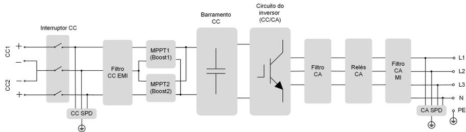
**Figura 2-4** Diagrama do circuito (SG5.0RT por exemplo)
