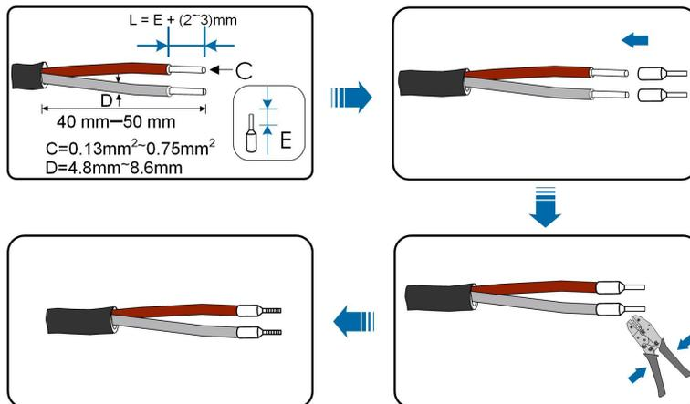
**Etapa 6** Conecte os condutores aos terminais correspondentes conforme mostrado na figura a seguir.
