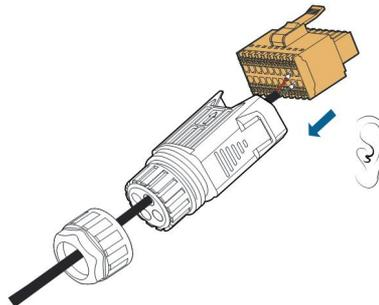
**Etapa 8 Para forma encadeada do RS485:** Conecte os dois condutores A e B aos respectivos terminais. Conecte estes terminais aos bornes A1 e B1 respectivamente.
