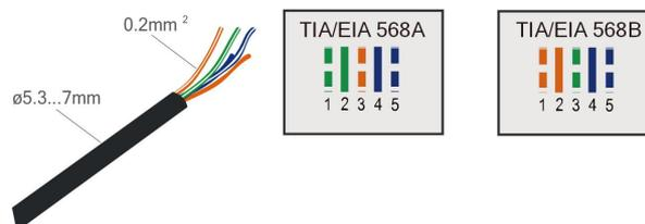
**Etapa 5** Conecte os condutores ao terminal correspondente conforme mostrado na figura a seguir.
