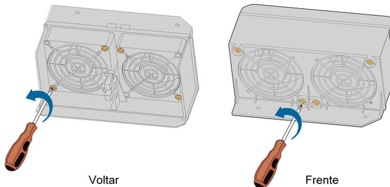
**Etapa 7** Utilize uma escova macia ou um aspirador de pó para limpar o ventilador. Se você precisar substituir o ventilador, utilize uma chave de fenda para soltar o parafuso do suporte e remova o ventilador.
