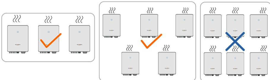
Instale o inversor a uma altura adequada para facilitar a visualização de indicadores LED e interruptores operacionais.
