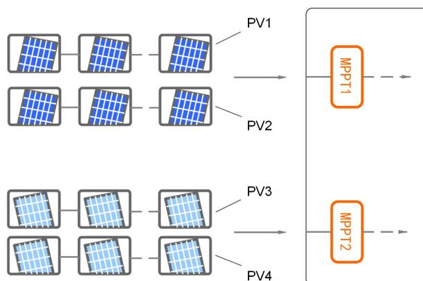
**Figura 5-3** Configuração das entradas FV (SG20RT-P2 por exemplo)
