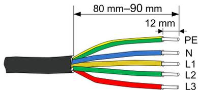
**Etapa 6 (Opcional)** Ao usar um cabo de fio de cobre de multi filamentos, conecte a cabeça do fio CA ao terminal da extremidade do cabo (apertar manualmente). No caso de condutores de cobre com filamento único, ignore esta etapa.
