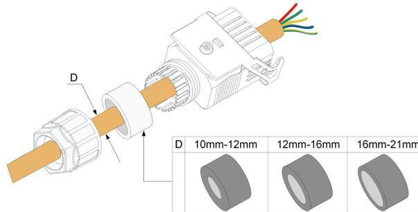
**Etapa 4** Remova 45 mm do revestimento e 12 a 16 mm do isolamento dos condutores..
