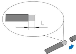
**Etapa 2** Crimpe as extremidades dos cabos utilizando os alicates adequados.
