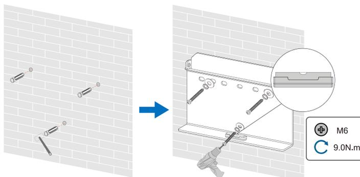
**Etapa 3** Levante o inversor e deslize-o para baixo ao longo do suporte de instalação de parede para certificar-se de que eles encaixam perfeitamente. Utilize o conjunto de fixadores para travar o dispositivo.
