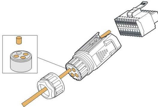
**Etapa 4** Remova o revestimento do cabo e retire o isolamento dos condutores.
