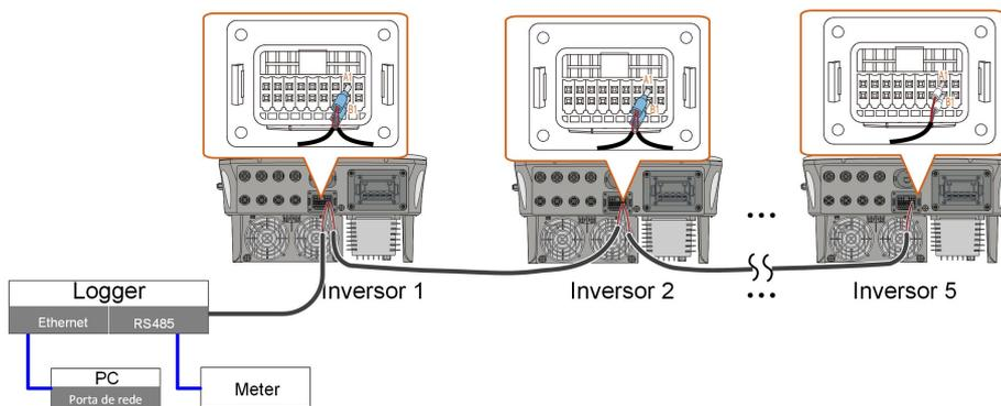
**Figura 5-6** Conexão com vários inversores
