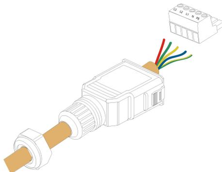
**Etapa 5** Remova de 80 a 90 mm do revestimento e 12 mm do isolamento dos condutores..
