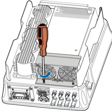
**Etapa 5** Levante o suporte, pressione a saliência no conector de alimentação dos ventiladores para baixo, puxe-a para fora e remova o suporte dos ventiladores.
