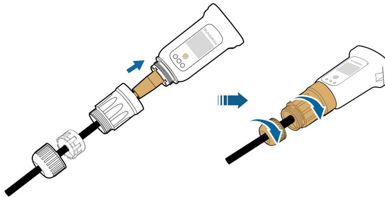
**Etapa 6** Remova a tampa à prova d'água do terminal **COM1** e instale o WiNet-S2.
